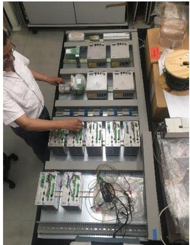
**Componentes de control de bajo nivel de mecanismos y del Housekeeping.**
