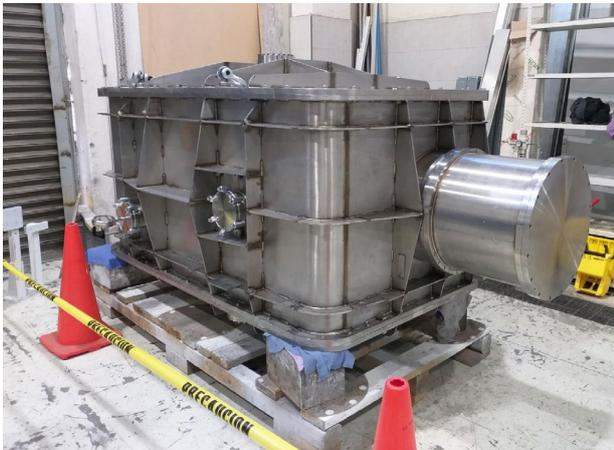
**Criostato de FRIDA listo para las pruebas de vacío en CIDESI.**
