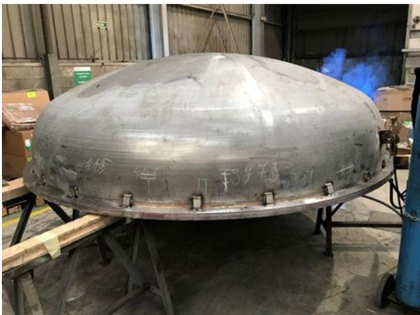
La tapa superior del criostato de pruebas en la fase final de fabricación.
