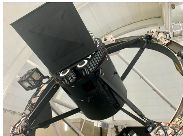
Vista del corrector focal y del rotador de campo en el foco primario del Telescopio WHT.
