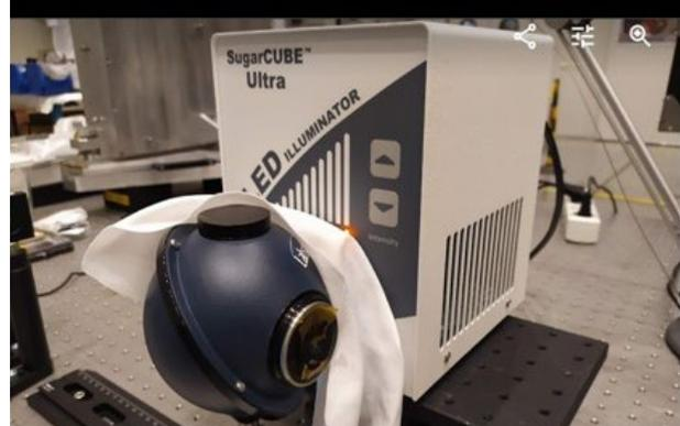
**Arriba: integración de un WFS (sensor de frente de onda) compuesto por la cámara, las microlentes y sus respectivas monturas. Abajo: fuente de luz con esfera integradora para simular la luz difusa que viene del Sol.**
