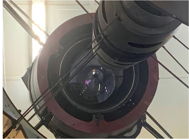
**Vista de la lente principal del corrector focal en el foco primario del Telescopio WHT.**
